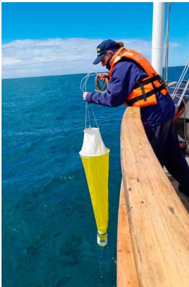
Muestreo de MPs en agua a bordo del Motovelero oceanográfico Dr. Bernardo Houssay, Prefectura Naval Argentina / Sampling of MPs in water aboard the oceanographic vessel MVO Dr. Bernardo Houssay, Prefectura Naval Argentina.
